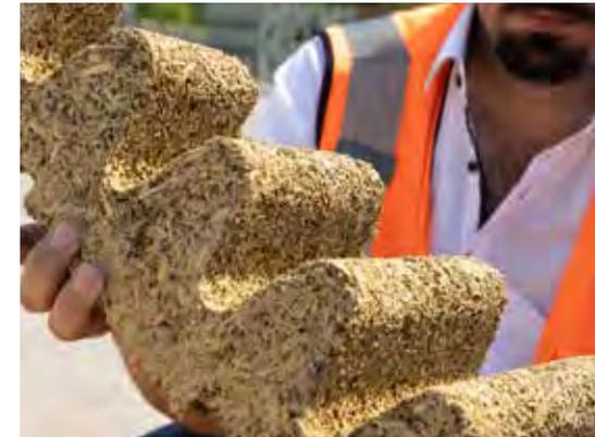
**Das Material aus zementgebundenen Holzfasern ist nachhaltig, absorbiert Schall und ist extrem haltbar. Der wellenförmige Querschnitt verhindert, dass die Schallwellen reflektiert werden.**
